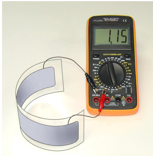
Рис. 3. Самодельный конденсатор емкостью порядка 1000 пФ, измеренной мультиметром
