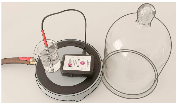
Рис. 2. Экспериментальная установка для демонстрации кипения жидкости при низком атмосферном давлении
