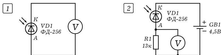
Рис. 1. Схемы включения фотодиода: 1 — фотогальванический режим работы; 2 — фотодиодный режим работы
