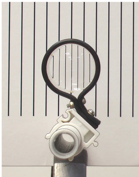
Рис. 9. Измерение фокусного расстояния окуляра
