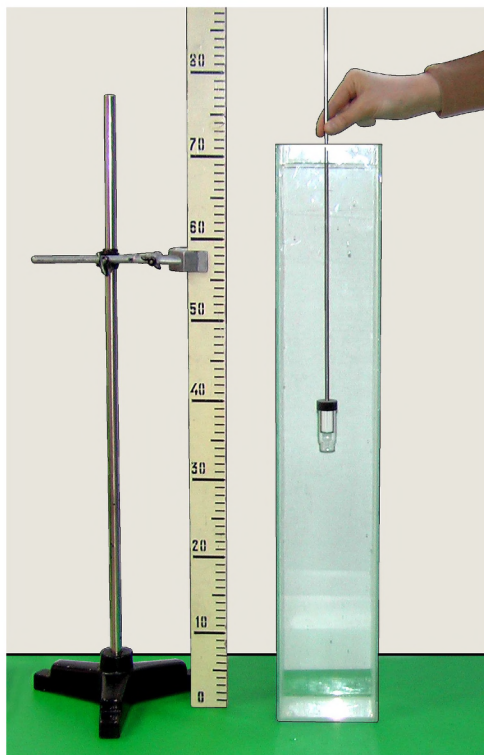
Рис. 1. Прямое измерение критической глубины погружения Картезианского водолаза. Перевернутая вверх дном пробирка с воздушным пузырем исходно плавает на поверхности. Медленное ее продвижение вниз увеличивает общее давление в пузыре, и его объем уменьшается. При этом уменьшается и сила Архимеда, которая на критической глубине становится равной силе тяжести
