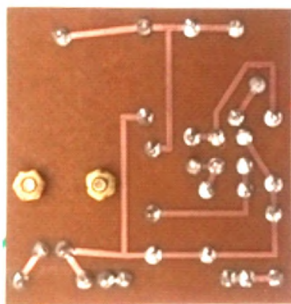
Рис. 6. Внешний вид обратной стороны электронного блока конвертера радиочастоты для приемника «Океан-214».
