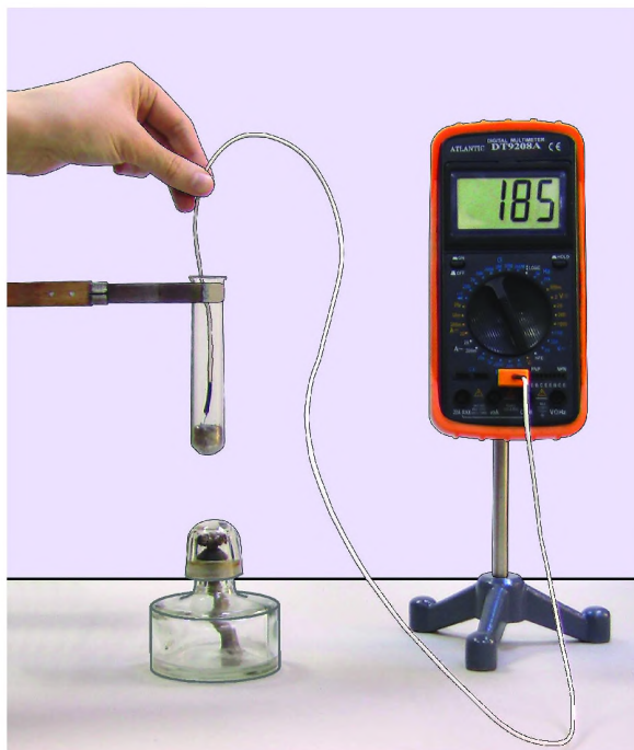
Рис. 4. Измерение температуры расплава с помощью термопары, подключенной к мультиметру
