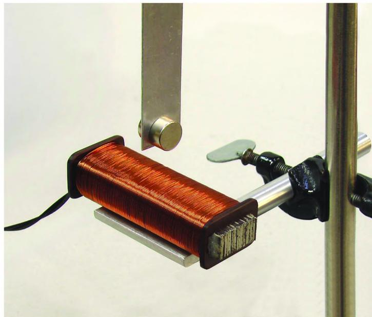
Рис. 4. Электромагнит расположен на специальном столике, который закреплен в штативе; над электромагнитом находится нижний конец маятника с двумя неодимовыми магнитами
