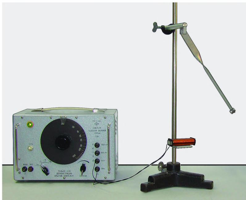
Рис. 5. Экспериментальная установка для учебного исследования магнитного маятника Дубошинского
