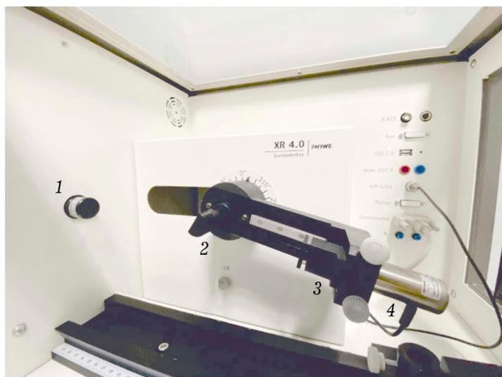
Рис. 5. Элементы установки для проведения измерений: 1 — диафрагма, 2 — монокристалл, 3 — диафрагма, 4 — счетчик Гейгера. Элементы 2, 3, 4 установлены на гониометре
