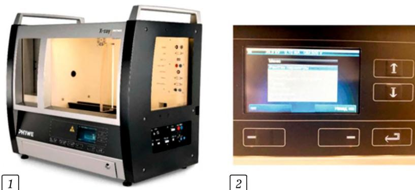
Рис. 1. Рентгеновская установка *PHYWE X-RAY 4.0*: 1 — внешний вид установки; 2 — внешний вид встроенной панели управления
