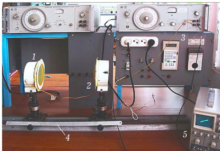
Рис. 1. Внешний вид стенда к лабораторной работе: 1 — динамик (источник звука); 2 — микрофон (приемник звука); 3 — звуковой генератор; 4 — линейка; 5 — осциллограф
