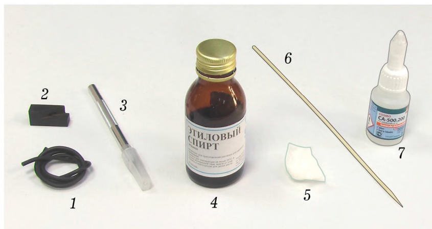
Рис. 18. Принадлежности для изготовления приводного ремня: 1 — шнур резиновый; 2 — приспособление для резки шнура; 3 — нож концевой; 4 — спирт этиловый; 5 — ватка; 6 — палочка для нанесения клея; 7 — клей Космофен
