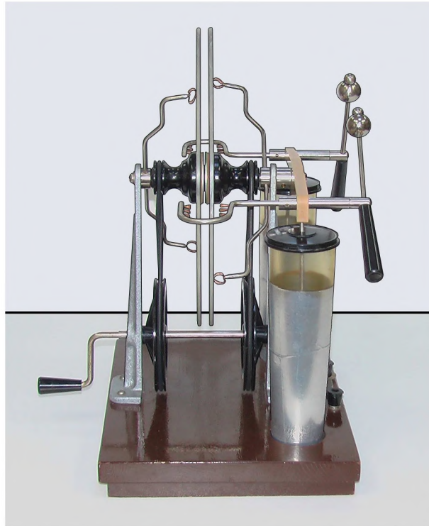
Рис. 2. Вид сбоку на отремонтированную электрофорную машину: показаны передняя (справа) и задняя (слева) стороны, верхняя и нижняя части машины
