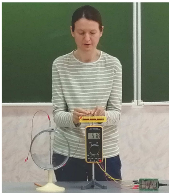
Рис. 7. Зарядка конденсаторного трансформатора от удвоителя напряжения. Фотография сделана в процессе проведения рассмотренной в статье экспертизы
