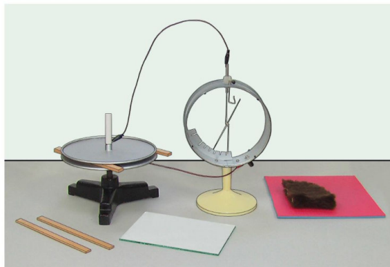
Рис. 4. Обоснование формулы для емкости плоского конденсатора в школьном демонстрационном эксперименте
