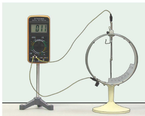
Рис. 3. Измерение мультиметром емкости демонстрационного электрометра для градуировки этого прибора по заряду
