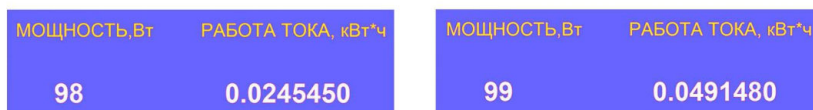
Рис. 8. Показания мощности и израсходованной электроэнергии 100 Вт лампой: а) в течение 15 мин с момента включения в сеть; б) в течение 30 мин
