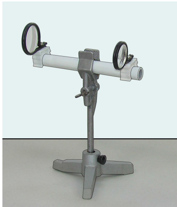
Рис. 3. Разработанная в процессе дидактического исследования учебная модель трубы Галилея
