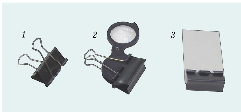
Рис. 8. Способ крепления элементов экспериментальных установок: 1 — большой канцелярский зажим шириной 51 мм; 2 — крепление вспомогательной линзы f_3 = 10 см; 3 — крепление белого экрана
