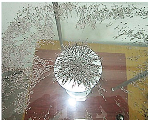
Рис. 7. Визуализация магнитного поля в горизонтальной плоскости железными опилками
