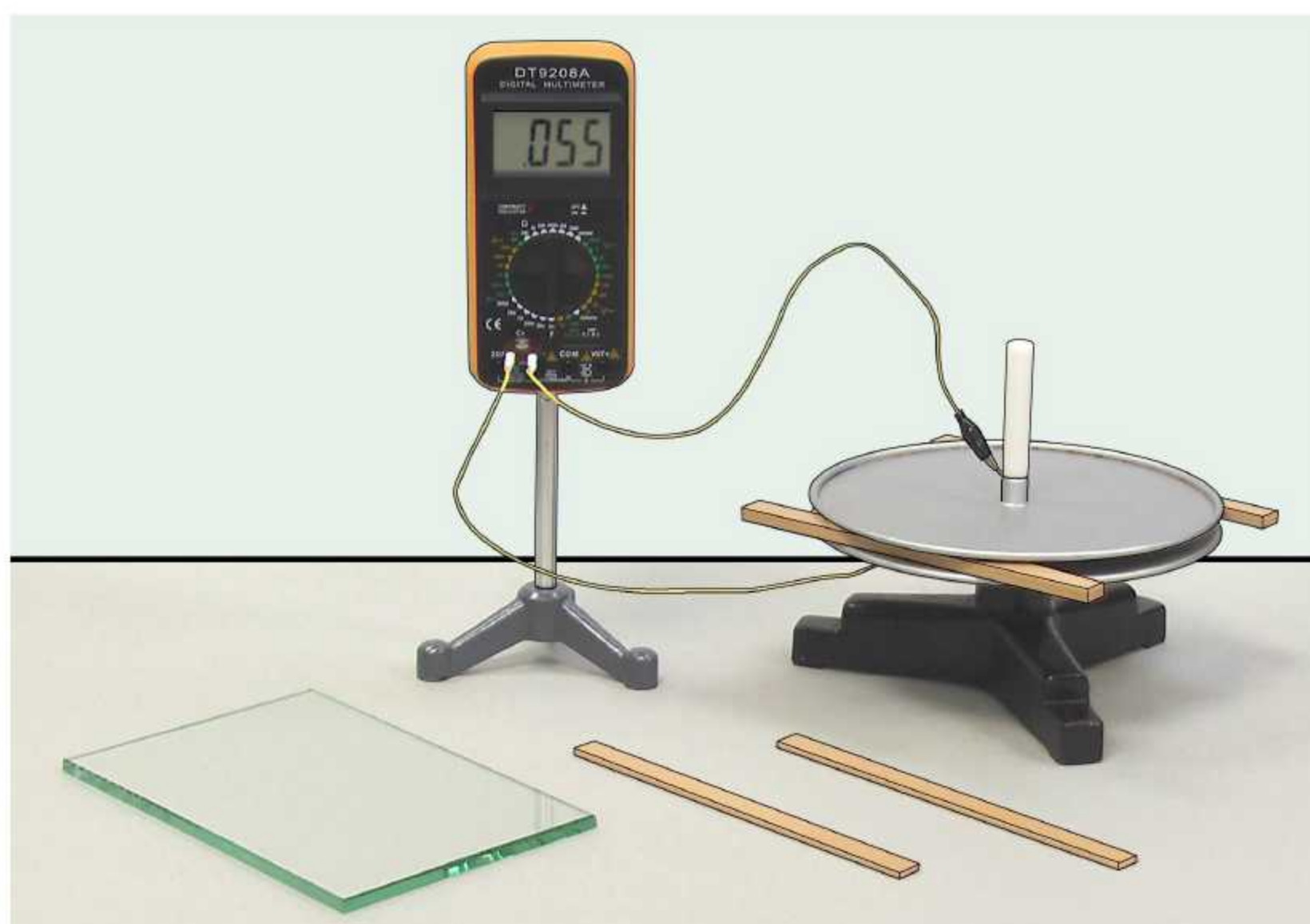
Рис. 5. Демонстрационный опыт по измерению емкости плоского конденсатора цифровым мультиметром
