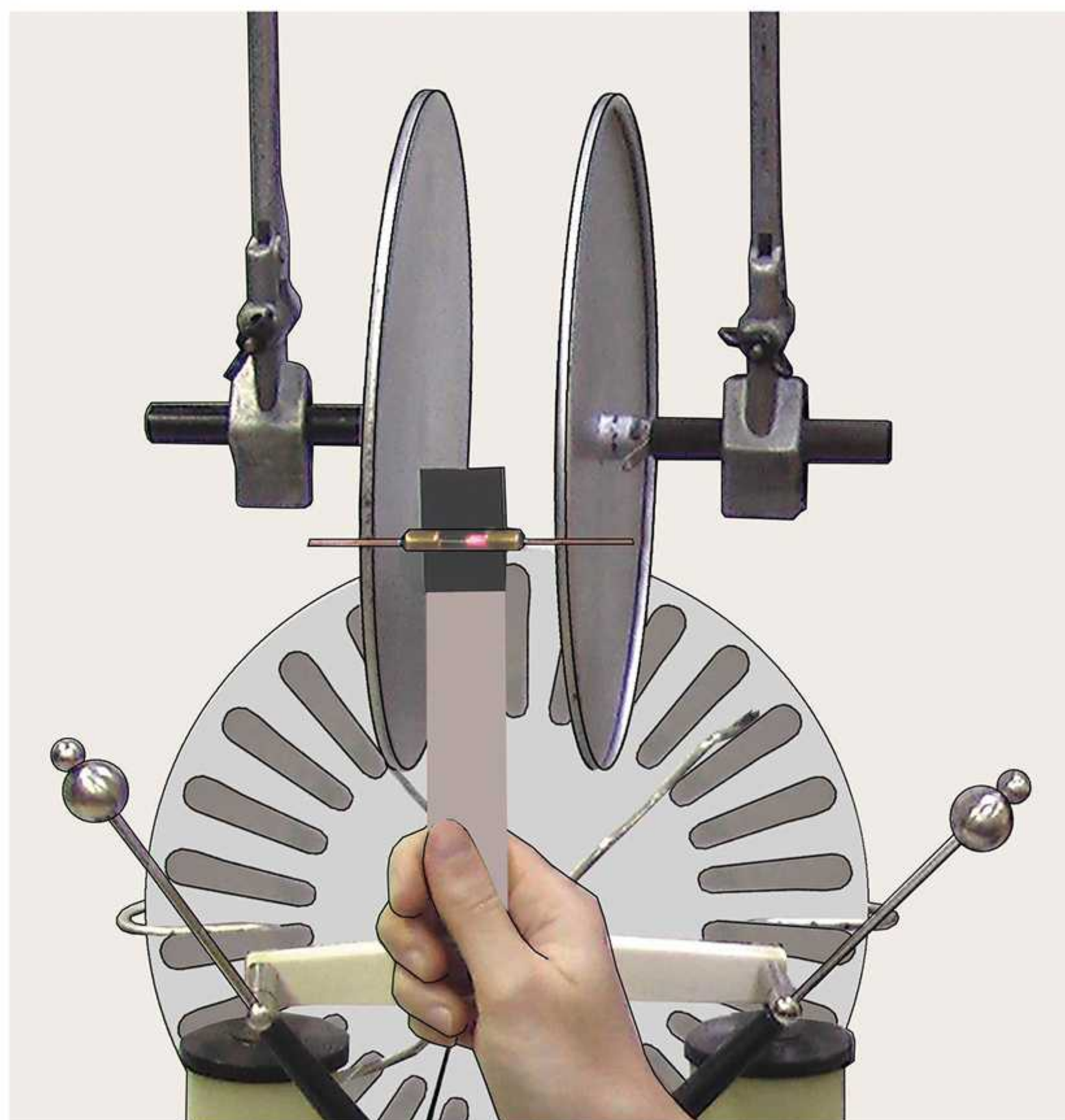
Рис. 5. Опыт, доказывающий, что при соединении пластин заряженного конденсатора проводником по проводнику проходит кратковременный ток разряда конденсатора
