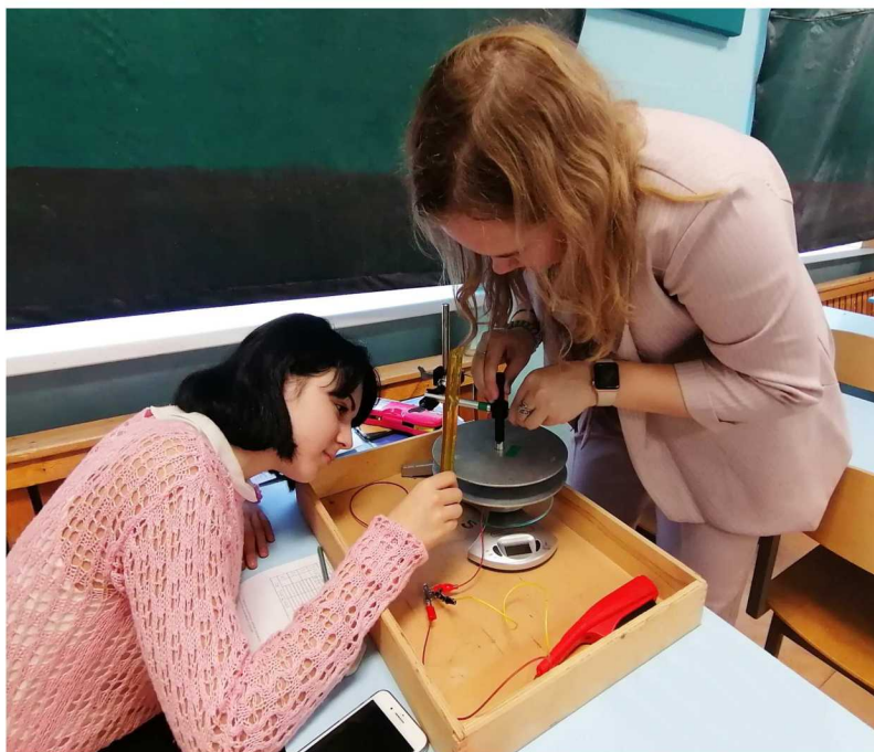
Рис. 3. Учащиеся выполняют эксперимент по измерению максимального напряжения пьезогенератора методом абсолютного вольтметра. В установке они используют бытовые электронные весы и пьезоэлектрическую зажигалку
